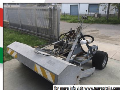
Macchina pulisci spiaggia portata da idonei trattori (90-120 HP) a quattro ruote motrici, muniti di sollevatore idraulico. Lavora per una larghezza di 200 cm. La capacità di lavoro indicata dal costruttore è da 15.000-25000 mq./h. La profondità di lavoro varia da 0 a 15 cm.
