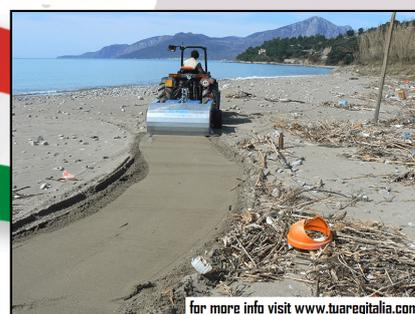
Macchina Puliscspiaggia della serie Pesante fino al 2011 da noi ancora prodotta. Caratteristiche e principio di funzionamento ampiamente collaudato nelle diverse condizioni degli arenili, gli permettono di operare anche in situazioni difficili: preparazione iniziale, dopo le mareggiate, sul bagnato, nelle spiagge con presenza di alghe, conchiglie, pietre, erba, ecc. E' comodissima per passare tra gli ombrelloni. Può essere applicata a qualsiasi tipo di trattore 40/60 CV.
