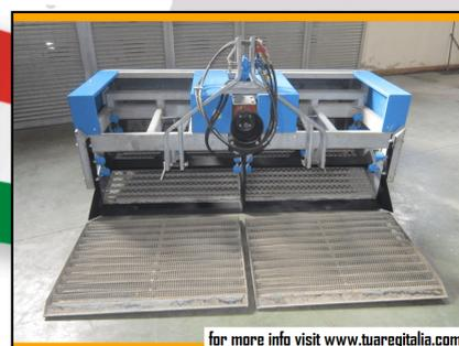
La máquina ha sido totalmente revisada y reparada en todas sus partes. Se han reemplazado todos los componentes desgastados. Algunos de los componentes utilizados en este limpiador de playas son similares a los utilizados en la nueva serie. El chasis y la carrocería son de la versión anterior de la "Super Series".
