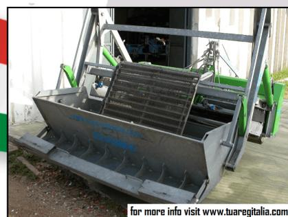
Limpiadora de playas transportada por tractores adecuados de tracción a las cuatro ruedas (80-90 CV), equipado con elevador hidráulico Funciona para un ancho de 190 cm. La capacidad de trabajo indicada por el fabricante es de 7000-15000 m<sup>2</sup> / hy más, dependiendo de la calidad de la arena (mojada, húmeda, seca) y las condiciones de la playa. La profundidad de trabajo, regulable mediante el elevador hidráulico del tractor, varía de 0 a 20 cm.
