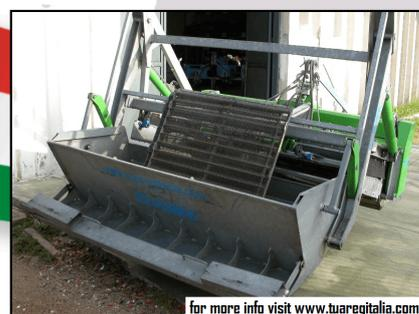
Machina de nettoyage de plage portée par des tracteurs à quatre roues motrices appropriés (80-90 CV), équipés d'un ascenseur hydraulique. Il fonctionne pour une largeur de 190 cm. La capacité de travail indiquée par le fabricant est de 7000-15000 m<sup>2</sup> / h et plus, en fonction de la qualité du sable (humide, humide, sec) et des conditions de la plage. La profondeur de travail, réglable au moyen du relevage hydraulique du tracteur, varie de 0 à 20 cm.
