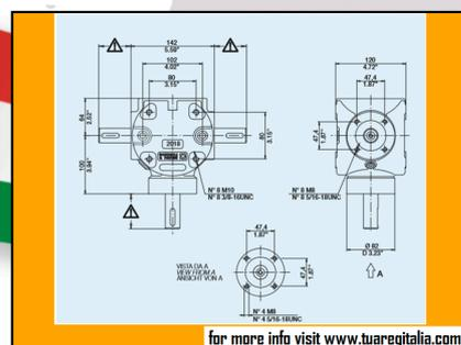
Scatole ad ingranaggi marca Bondioli & Pavesi. Come dimostrato dalle foto è in ghisa ed è nuova. Ingresso comune attacco scanalato per giunto cardanico e uscita "doppia" con albero liscio diametro 22 mm e chiavetta misura 6x6x30 mm. Rapporto 1:1,35, con potenza 20 cv. Questa scatola viene venduta in negozio al prezzo di circa 350 euro
