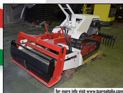
Le nettoyeur de plage S90 est une machine automotrice sur chenilles à fonctionnement manuel, idéale pour nettoyer les zones sablonneuses. La vitesse de la machine et le fonctionnement du tamis sont indépendants l'un de l'autre grâce à un système HYDROSTATIQUE qui la rend unique dans le secteur contrairement aux machines à transmission mécanique traditionnelles.
